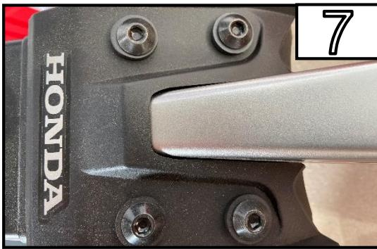
Entfernen Sie die 4 Schrauben
