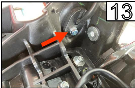
Entfernen Sie die Schrauben der Blinker
