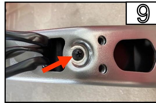
Entfernen Sie die Schraube
