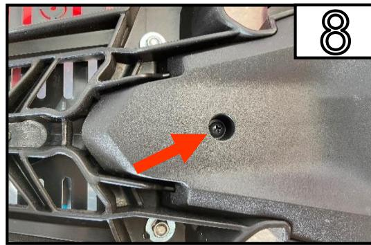
Entfernen Sie die Schraube
