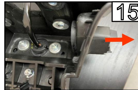
Entfernen sie den Blinker Halter
