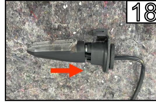
Führen Sie das Blinker Kabel in den Blinker
