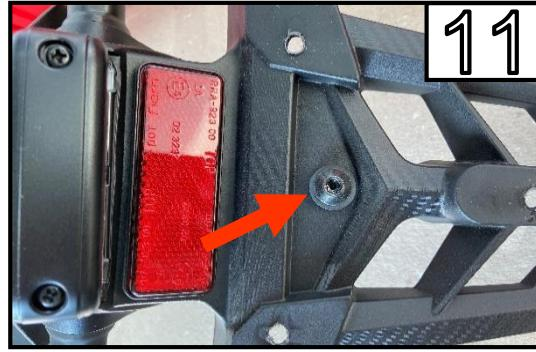
Entfernen Sie die Schraube
