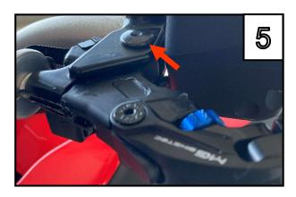
Kupplungsseil in den MG Biketec Hebel einhängen und führen Sie den Hebel vorsichtig auf seine Position.
