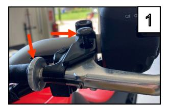
Entfernen Sie die Befestigungsschraube. Entspannen Sie das Kupplungsseil, durch Verstellen des Rades. Drehen Sie das Rad auf offene Position um das Kupplungsseil auszuhängen.
