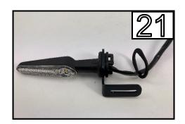
Entfernen Sie den Blinker vom Kennzeichenträger / Remove the indicators from the license plate holder
