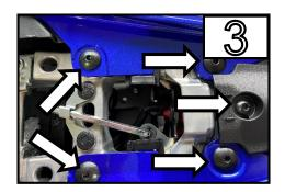
Entriegeln Sie die Sitzbank und entfernen Sie diese / Unlock and remove the pillion seat Entfernen Sie die beiden Schrauben für den Fahrersitz /
