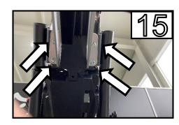
Ziehen Sie den Clip heraus und öffnen Sie den Ring für den Kabelbaum Pull out the clip and open the ring for the wiring harness /
