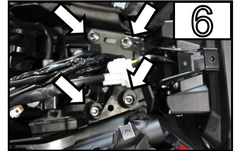
Lösen Sie alle 4 Schrauben/
