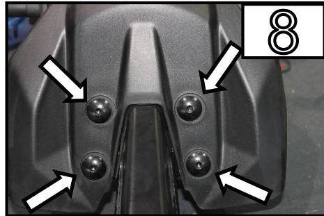
Lösen Sie alle 4 Schrauben /
