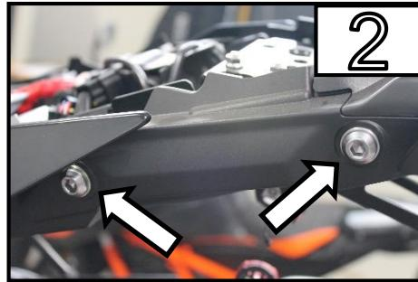
Lösen Sie die Beiden Schrauben /
