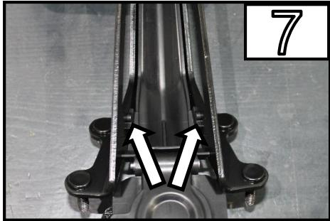
Lösen Sie die beiden Klips /
