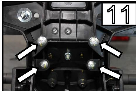
Lösen Sie alle 4 Schrauben /
