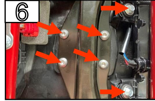
Entfernen Sie die 6 Schrauben.
