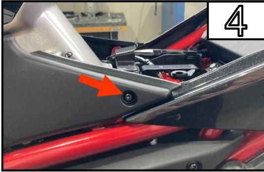
Entfernen Sie die Schraube ( L&R ) und die beiden seitlichen Verkleidungen.
