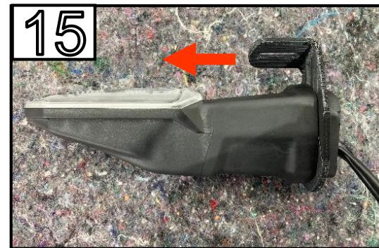
Montieren Sie den Blinker in der Halterung
