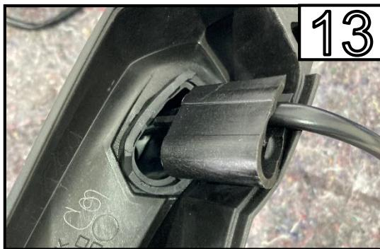
Entfernen Sie das Kunststoffstück aus dem Blinker.
