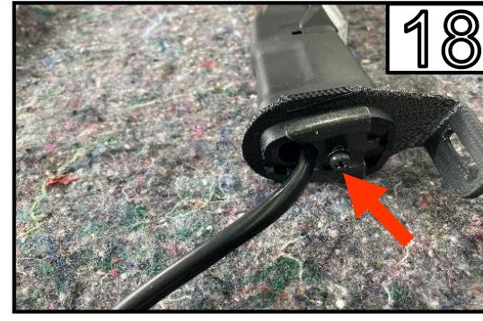
Befestigen Sie das Sicherungsblech wieder am Blinker mit der Schraube.
