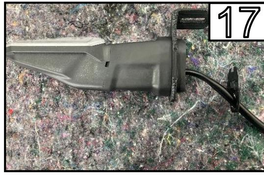
Montieren Sie die Metallplatte wieder im Blinker.
