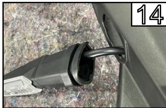
Entfernen Sie den Blinker aus der Halterung.
