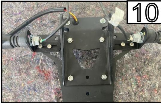
Montieren Sie die Blinker mit der Halterung mit den M4 Schrauben auf der Kennzeichenplatte.
