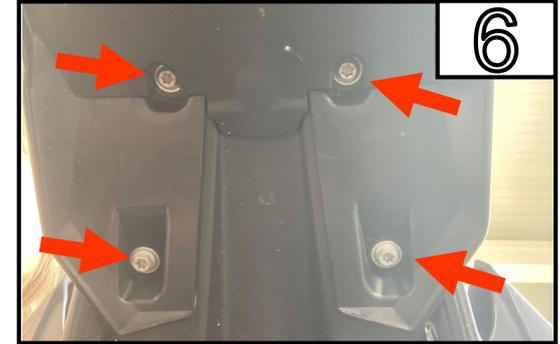
Entfernen Sie die 4 Schrauben und nehmen Sie vorsichtig die Kennzeichenhalterung ab.
