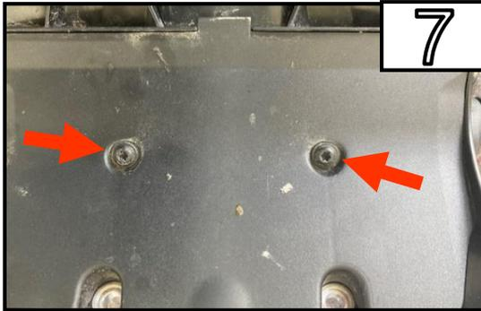
Entfernen Sie die 2 Schrauben und die Abdeckung am Kennzeichenträger.
