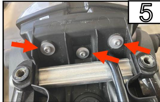
Entfernen Sie die 3 Schrauben und danach die Rückleuchte.
