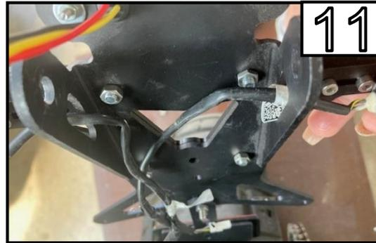
Beide Blinker Kabel durch die Aussparung an der Kennzeichenplatte Adapter führen.
