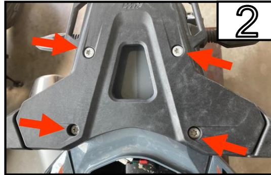
Entfernen Sie die 4 Schrauben.
