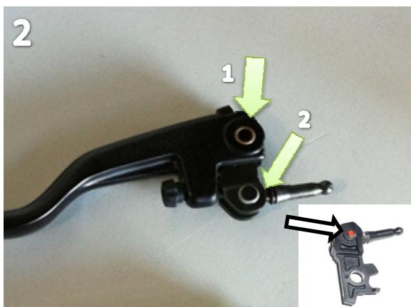
Hülse des Originalhebels mit Hilfe eines 8mm Dorn herausdrücken
