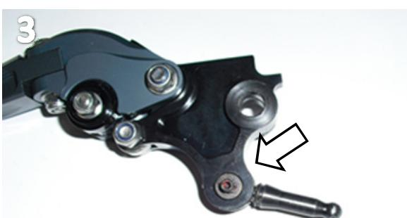
Originale Kolbenstange und Buchse in Hebel verbauen und dabei etwas Schmierfett verwenden
