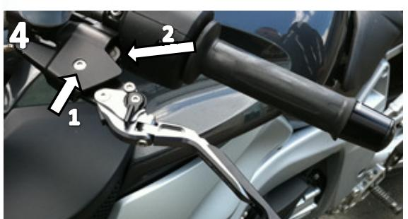
Bauen Sie den Hebel mit der originalen Hülse, Originalschraube und -mutter wieder an. Ziehen Sie die Mutter mit einem Drehmoment von 4,5 Nm fest (Bild 4-1).
