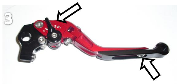
Der Hebel ist durch Drehen des Verstellhebels in 7 Positionen im Abstand einstellbar.
