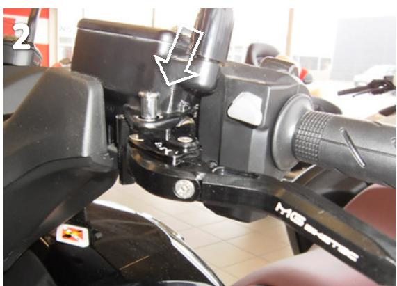
Bauen Sie den Hebel mit der Originalschraube und -mutter wieder an. Ziehen Sie die Mutter mit einem Drehmoment von 6 Nm fest (Bild 2).
