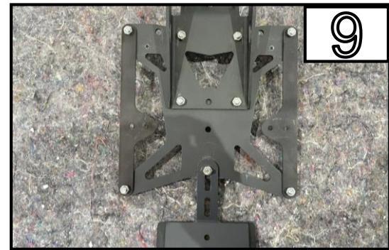
Montiere Sie die Blinkerhalter mit den mitgelieferten Schrauben am Kennzeichenträger.
