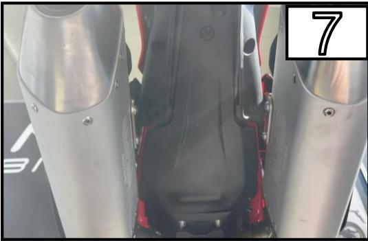
Montieren Sie die originale Abdeckung mit den Schrauben wieder am Bike.
