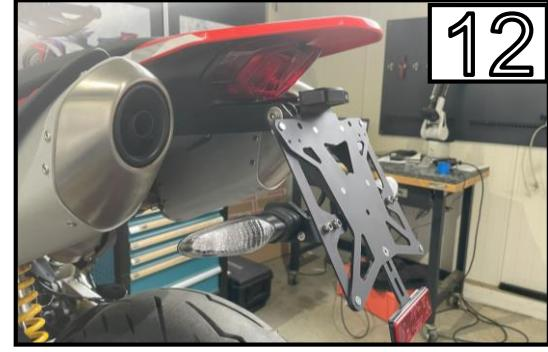
Verbinden Sie den Adapter mit der Kennzeichenplatte mit den mitgelieferten M8 Schraubenset und verbinden Sie die Kabel.
