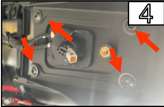
Entferne Sie die 4 Schrauben und den originalen Kennzeichenhalter
