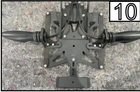
Montieren Sie die Blinkerhalter am Kennzeichenträger
