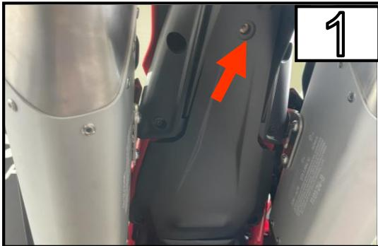
Entfernen Sie die Schraube.
