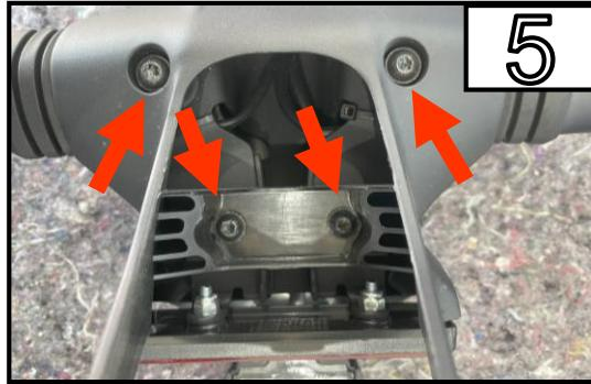
Entfernen Sie die 4 Schrauben, die Abdeckung und die Blinker aus dem Kennzeichenhalter.
