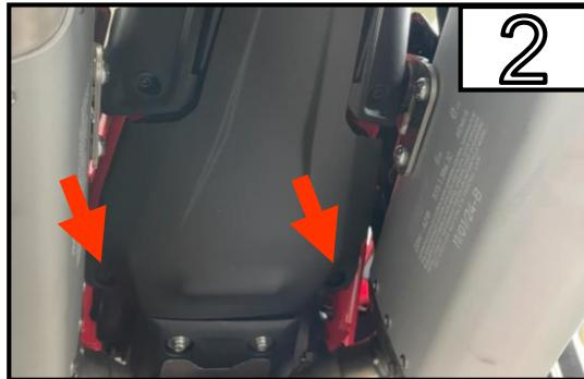
Entfernen Sie die 2 Schrauben und danach die Abdeckung.
