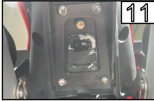
Montieren Sie den Bike Adapter mit den mitgelieferten Schrauben am Bike.
