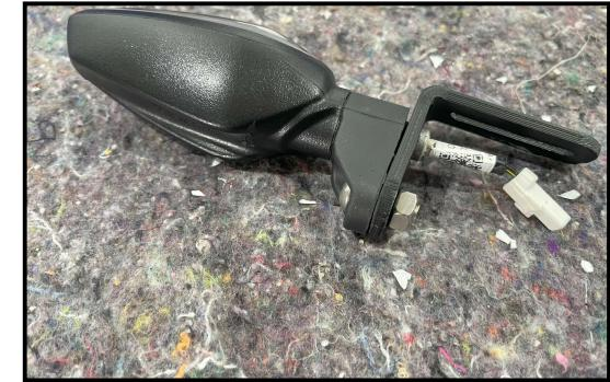
Verschrauben Sie den Blinker mit den Blinkerhalter.
