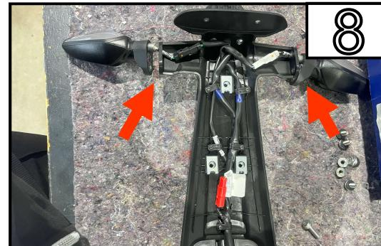
Trennen Sie die Kabel der Blinker und entfernen Sie diese aus dem originalen Kennzeichenträger.
