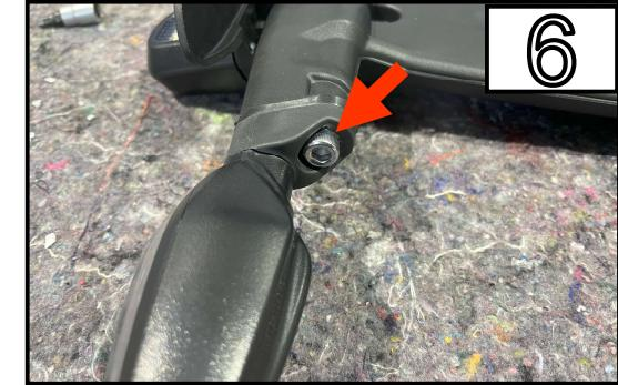
Entfernen Sie die 3 Schrauben.
