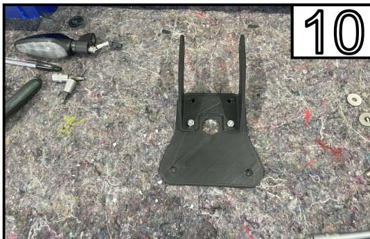
Verschrauben Sie den Bike Adapter mit der Grundplatte.
