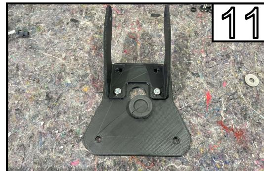
Führen Sie den Stoppel in die Kabeldurchführung.
