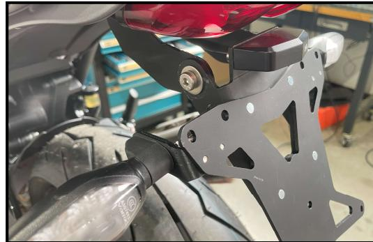
Verbinden Sie den Adapter mit der Kennzeichenplatte mit der mitgelieferten M8 Schrauben, Beilagscheiben und Mutter.
