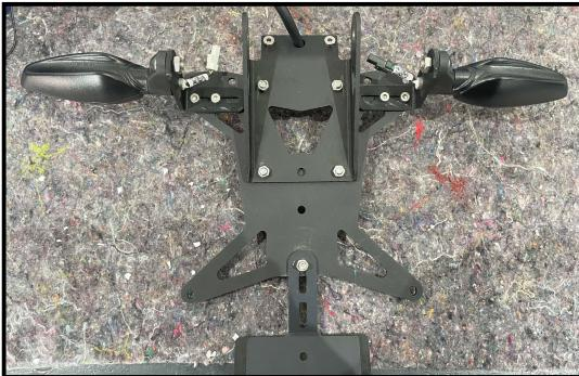
Montieren Sie die Blinkerhalter am Kennzeichenträger.
