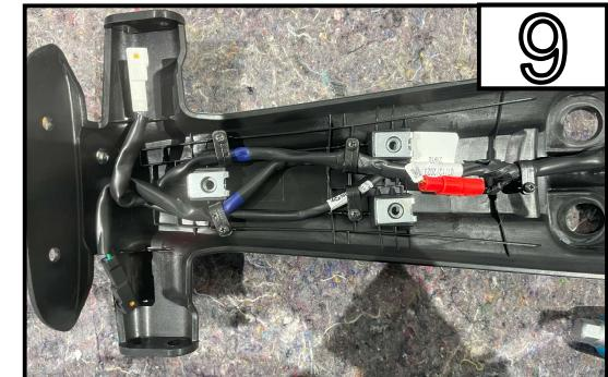
Entfernen Sie den Kabelbaum aus dem Kennzeichenträger.
