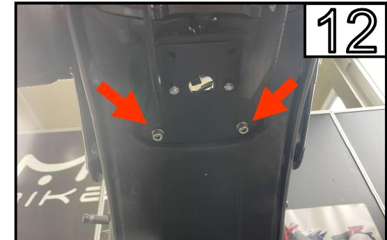
Verschrauben Sie den Bike Adapter hinten mit den mitgelieferten M6x25 Schrauben.
