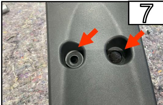
Entfernen Sie die 2 Gummihülsen und entfernen Sie die Abdeckung am Kennzeichenträger.
