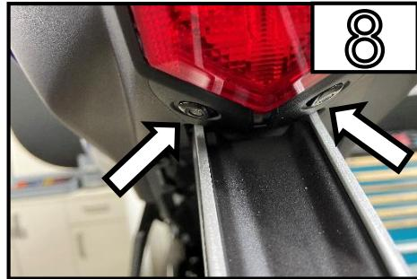
Entfernen Sie die beiden Kunststoffclips unter dem Rücklicht /
