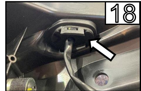
Entfernen Sie die Sicherungsplatte des Blinkers /
