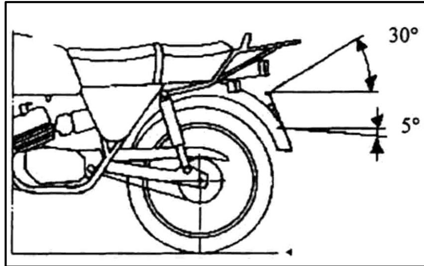
Richten Sie nun, den Kennzeichenträger so am Fahrzeug aus (Schraube A), dass er symmetrisch am Fahrzeugs sitzt und vom Winkel den gesetzlichen Anforderungen von 30° entspricht (siehe oberes Bild).
