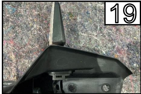
Entfernen Sie den Blinker vom Kennzeichenträger /
