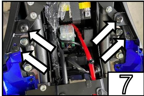
Entfernen Sie auf beiden Seiten die Schrauben und die Kunststoffclips /
