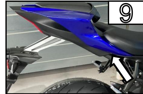
Entfernen Sie auf beiden Seiten den gezeigten Kunststoffclip /
