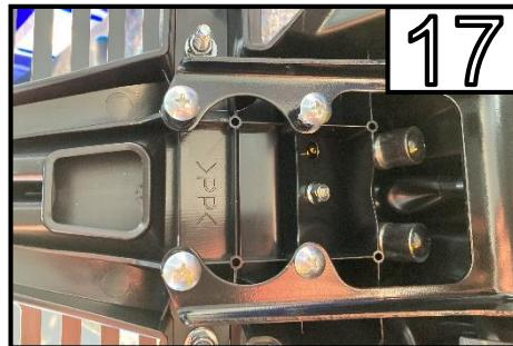
Entfernen Sie den Metallbügel indem Sie die 4 Schraube entfernen
