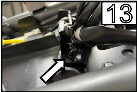
Ziehen Sie den Clip heraus und öffnen Sie den Ring für den Kabelbaum
