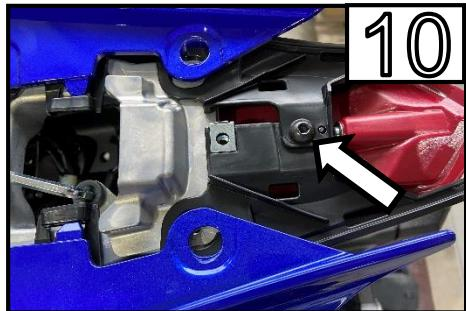
Entfernen Sie die Schraube und im Anschluss die schwarze Kunststoffabdeckung /
