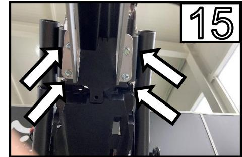
Entfernen Sie die 4 Schrauben und nehmen Sie den Kennzeichenträger ab /
