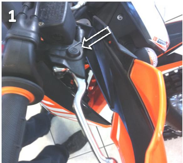
Entfernen Sie die originale Befestigungsschraube indem Sie die Mutter an der Unterseite abdrehen und anschließend die Schraube herausdrehen (Bild 1)
