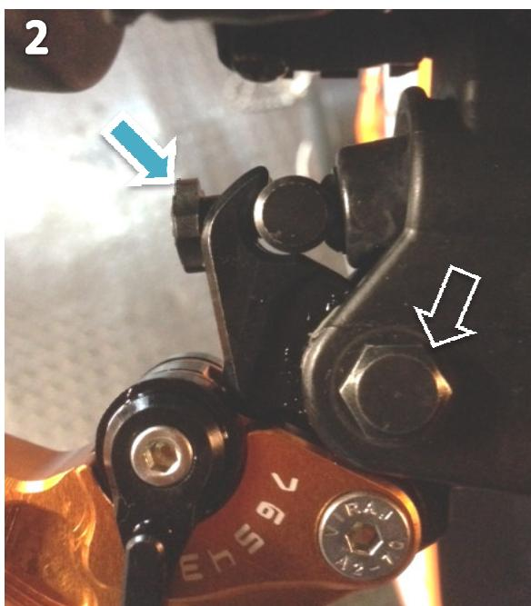
Bauen Sie den Hebel mit der Originalschraube und -mutter wieder an. Und setzen dabei die Einstellschraube und den Druckbolzen wieder ein. Ziehen Sie die Mutter mit einem Drehmoment von 6 Nm fest (Bild 2).
