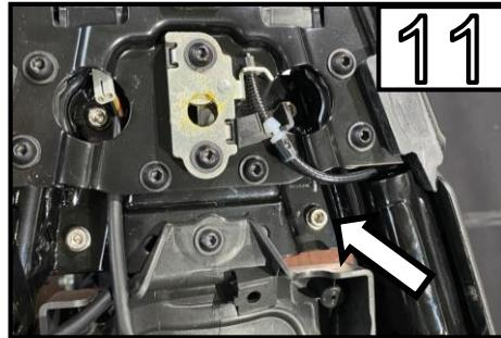
Stecken Sie nun die 4 mitgelieferten M6 Schrauben und Beilagscheiben von oben in den Heckrahmen /
