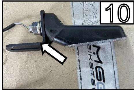
Befestigen Sie den Blinker mit der originalen Mutter in der Halterung /
