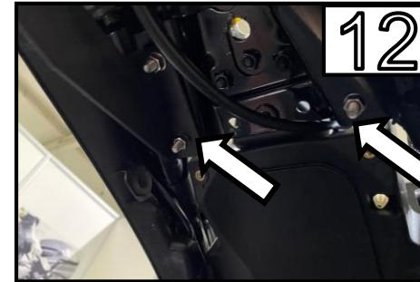
Montieren Sie nun die beiden neuen Träger mit den M6 Scheiben und Mutter. Ziehen Sie diese noch nicht komplett fest.
