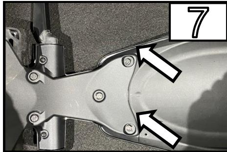
Demontieren Sie die untere Abdeckung des Kennzeichenträgers /
