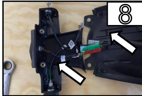
Trennen Sie die Kabel und Demontieren Sie die Blinker, Bitte beachten Sie nun Seite 7 zur Kabelverbindung /
