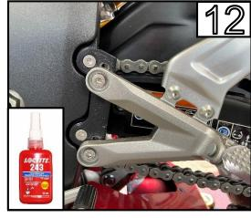
Führen Sie Schritt 1-3 in umgekehrter Reihenfolge durch / Proceed with steps 1-3 in reverse Demontieren Sie die originale linke Fußrastenanlage. Entfernen Sie dazu die beiden im Bild gezeigten Schrauben. /
