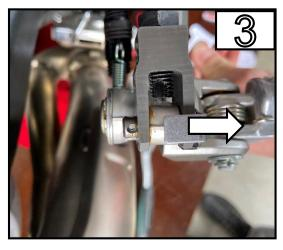
Entfernen Sie zuerst die Schrauben (1), welche den Bremszylinder an der Fußraste hält. Danach entfernen Sie die beiden Schrauben (2), die die Fußrasten am Motorrad hält. /
