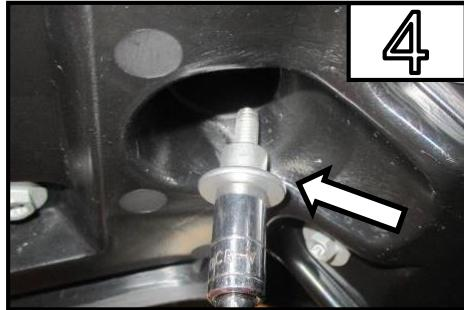
Entfernen Sie die Schraube.
