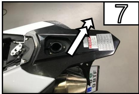
Entfernen Sie den Kotflügel.
