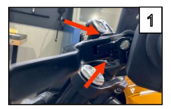
Entfernen Sie die Befestigungsschraube indem Sie die Mutter an der Unterseite abdrehen. Anschließend können Sie die Schraube herausdrehen. Montieren Sie vorsichtig den Originalhebel ab.
