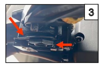
Anschließend auf der Unterseite die Mikroschalter Halterung richtig platzieren und mit der Mutter befestigen. Ziehen Sie die Mutter mit einem Drehmoment von 6 Nm fest.
