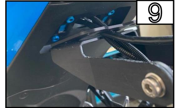
Montieren Sie das neue Heck am Motorrad mit dem mitgelieferten M6 Schraubenset
