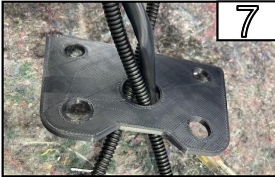
Führen Sie die Kabel durch den Ausschnitt am Bike Adapter.
