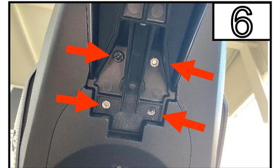
Entfernen Sie die 4 Schrauben und nehmen Sie vorsichtig die Kennzeichenthalterung ab.
