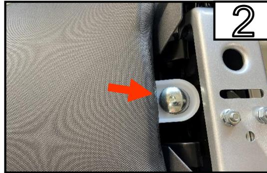
Entfernen Sie die Schraube.
