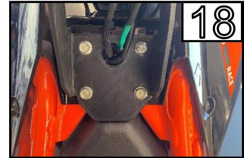
Montieren Sie den Kennzeichenträger mit den 4 originalen Schrauben am Rahmen. /
