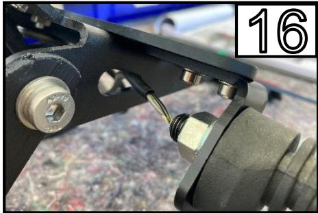
Montieren Sie die Blinker mit den beigelegten Haltern am Kennzeichenträger. /
