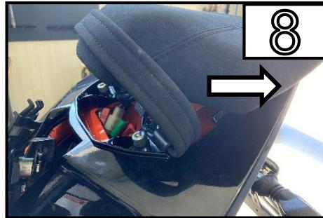
Entfernen Sie den Sitz vom Motorrad indem Sie den Sitz nach hinten aus der Schlaufe hinaus ziehen. /
