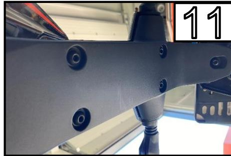
Entfernen Sie auf der Unterseite des Kennzeichenträgers alle 5 Schrauben (Kunststoffteil geht dann ab). /
