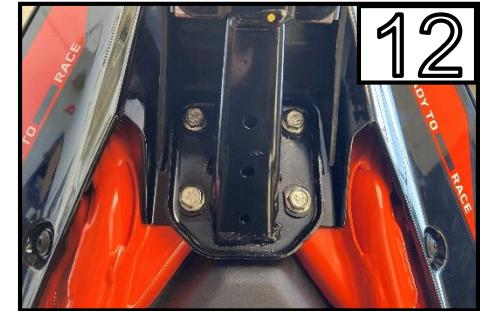
Entfernen Sie die 4 Schrauben und nehmen Sie dann den Kennzeichenträger ab. (Schauben werden wieder verwendet). /
