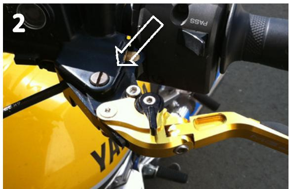
Bauen Sie den Hebel mit der Originalschraube und -mutter wieder an. Ziehen Sie die Mutter mit einem Drehmoment von 6 Nm fest (Bild 3).
