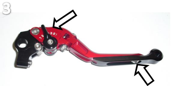
Der Hebel ist durch Drehen des Verstellhebels in 7 Positionen im Abstand einstellbar.
