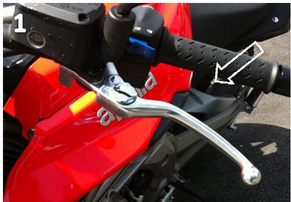
Entfernen Sie die originale Befestigungsschraube indem Sie die Mutter an der Unterseite abdrehen und anschließend die Schraube herausdrehen (Bild 1)
