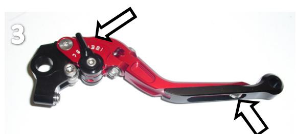
Bauen Sie den Hebel mit der Originalschraube und -mutter wieder an. Ziehen Sie die Mutter mit einem Drehmoment von 6 Nm fest (Bild 2).
