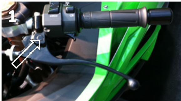
Entfernen Sie die originale Befestigungsschraube indem Sie die Mutter an der Unterseite abdrehen und anschließend die Schraube herausdrehen (Bild 1)
