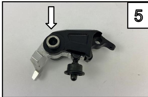
Pressen Sie die Hülse nun wieder in den neuen MG Biketec Adapter ein (**von oben nach unten** – Hülse geht auf der obere Seite beim MG Biketec Adapter leicht rein) /
