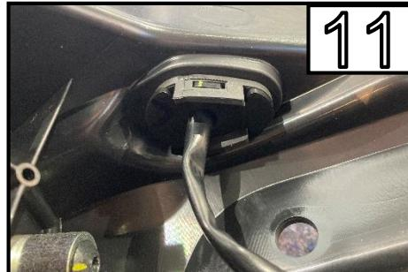
Entfernen Sie die Sicherungsplatte des Blinkers /
