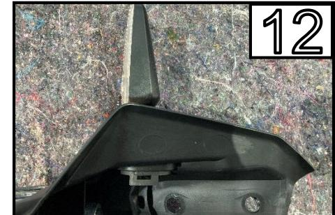
Entfernen Sie den Blinker vom Kennzeichenträger /
