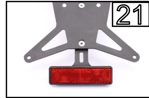
Führen Sie die Stehbolzen des Kennzeichenträger durch die originalen Bohrungen durch /
