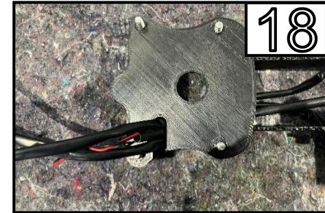
Führen Sie die Grundplatte wie im Bild gezeigt, auf die Stehbolzen /
