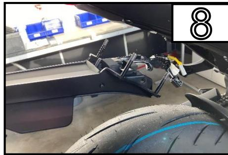
Entfernen Sie den Kennzeichenträger vom Motorrad /
