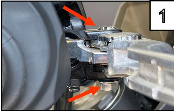
Entfernen Sie die Befestigungsschraube indem Sie die Mutter an der Unterseite abdrehen und anschließend die Schraube herausdrehen. Montieren Sie vorsichtig den Originalhebel ab.
