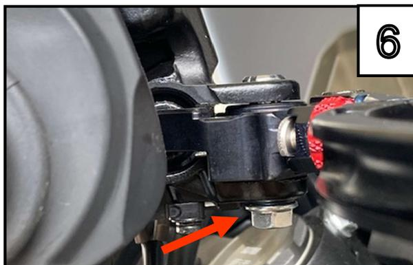
Anschließend auf der Unterseite mit der Mutter befestigen. Ziehen Sie die Mutter mit einem Drehmoment von 6 Nm fest.
