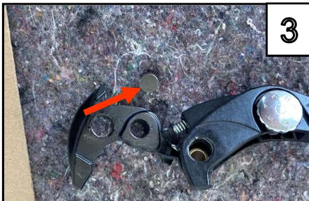
Zerlegen Sie den Originalhebel und entnehmen Sie die Buchse.
