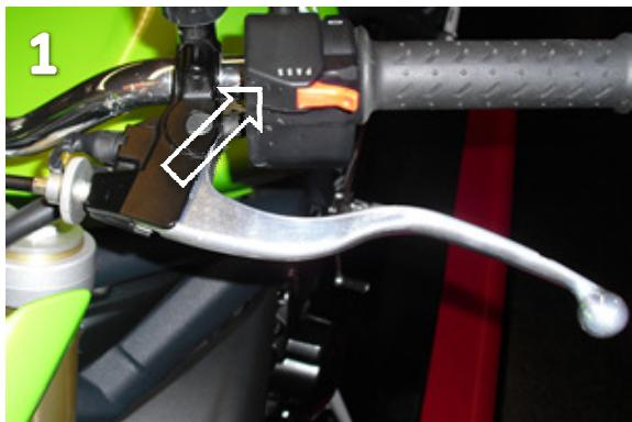
Entfernen Sie die originale Befestigungsschraube indem Sie die Mutter an der Unterseite abdrehen und anschließend die Schraube herausdrehen (Bild 1)
