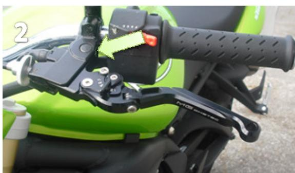
Originale Lagerbuchse aus Hebel entnehmen
