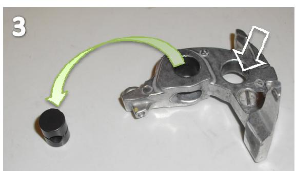
Originale Buchse in Hebel verbauen und dabei etwas Schmierfett verwenden (Bild 4)
