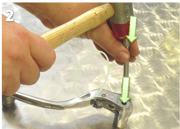
Hülse von der Unterseite des Originalhebels mit Hilfe eines 10mm Dorn herausdrücken
