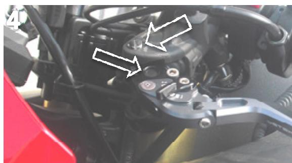
Bauen Sie den Hebel mit der Originalschraube und -mutter wieder an. Ziehen Sie die Mutter mit einem Drehmoment von 6 Nm fest (Bild 4).
