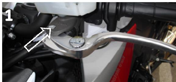
Entfernen Sie die originale Befestigungsschraube indem Sie die Mutter an der Unterseite abdrehen und anschließend die Schraube herausdrehen (Bild 1)
