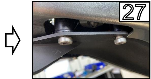
Montieren Sie den Kennzeichenträger am Motorrad. Verwenden Sie hier die mitgelieferten Distanzhülsen /
