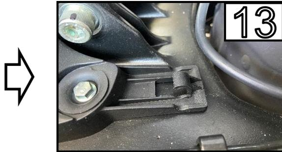
Entfernen Sie das Kabel aus der Führung
