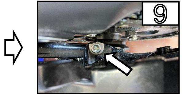
Entfernen Sie die Schraube von Kettenschutz vorne /
