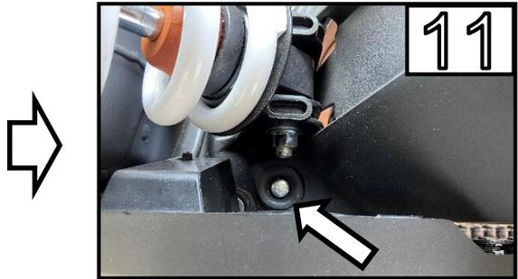
Entfernen Sie die Schraube von Kettenschutz beim Federbein /
