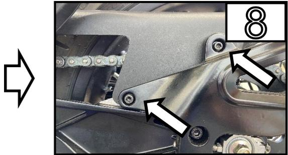
Entfernen Sie die beide Schrauben von Kettenschutz hinten /
