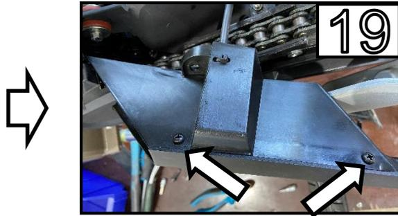
Entfernen Sie die beiden Schrauben /
