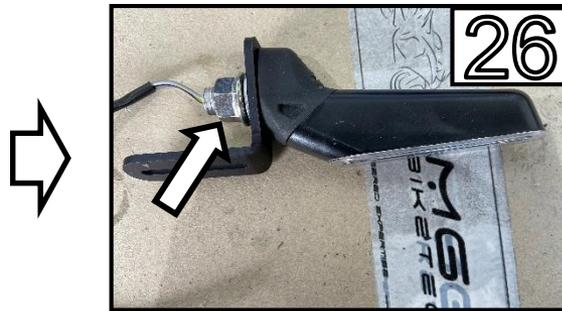
Befestigen Sie den Blinker mit der originalen Mutter in der Halterung /
