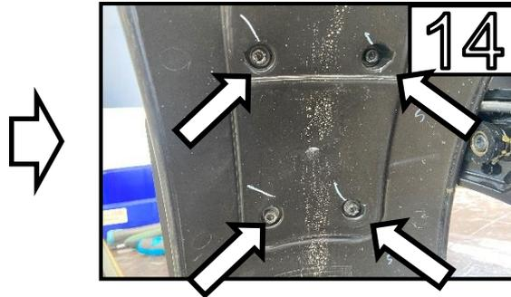
Entfernen Sie die Schrauben /
