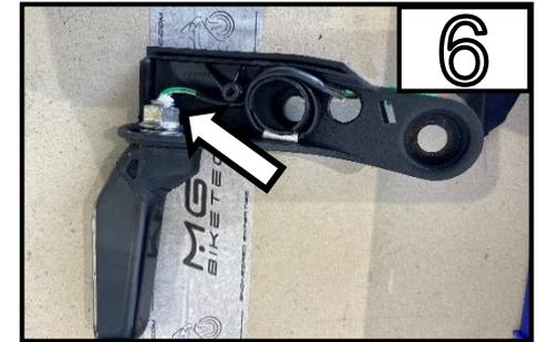
Entfernen Sie die Mutter vom Blinker und entfernen Sie diesen von der Halterung /
