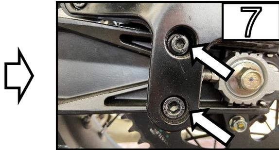
Entfernen Sie die beide schrauben von Kennzeichenträger /
