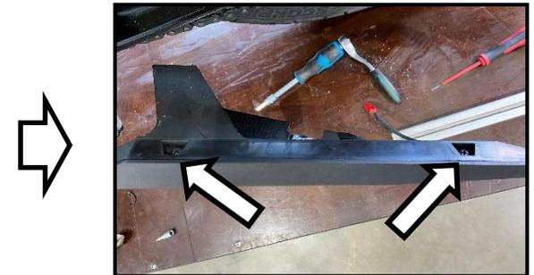
Entfernen Sie die beiden Schrauben /
