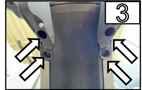
Entfernen Sie alle 4 Schrauben der Blinkerhalterung /
