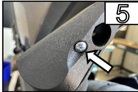
Entfernen Sie die Schraube am Gehäuse der Blinkerhalterung /
