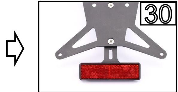
Montieren sie den beigelegten Reflektor am MG Biketec Kennzeichenträger /
