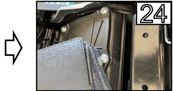
Führen Sie das Kabel unter dem Tank
