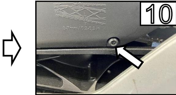
Entfernen Sie die Schraube von Kettenschutz mittig /
