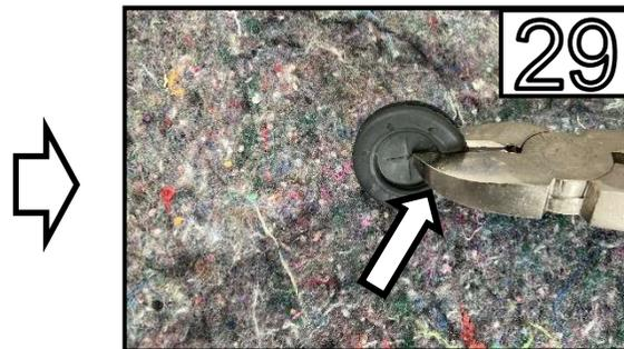
Schneiden Sie den Gummi auf einer Seite auf für die Kabel. /
