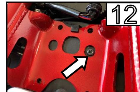
Entfernen Sie die Kreuzschraube und stützen Sie den Träger am Hinterrad ab / Remove the black screw and place the license plate holder on the rear tire.
