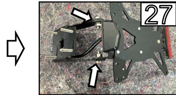
Verbinden Sie den Adapter mit der Kennzeichenplatte mit der mitgelieferten M8 Schrauben, Beilagscheiben und Muttern /
