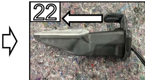
Montieren Sie den Blinker in der Halterung
