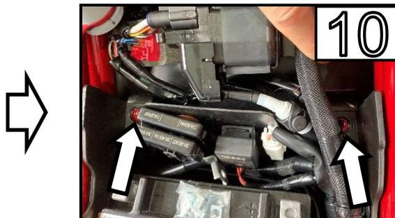
Entfernen Sie die beiden Schrauben neben der Batterie / Remove both bolts near the battery
