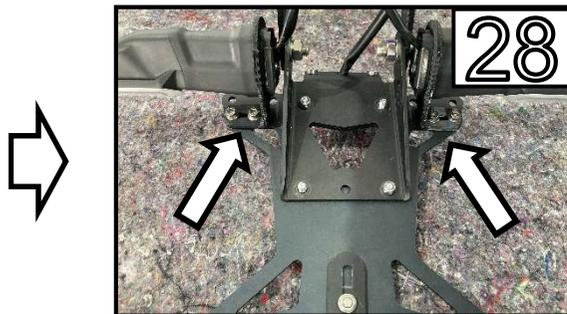
Montieren Sie die Blinkerhalter am Kennzeichenträger. /
