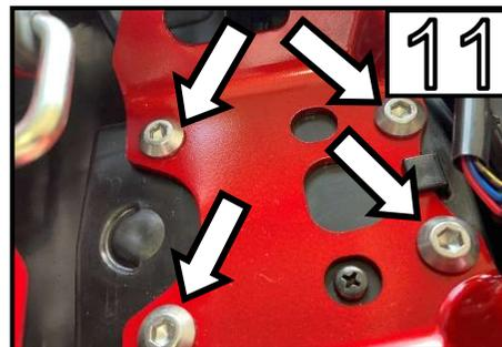
Halten Sie den Kennzeichenträger und entfernen Sie alle 4 markierten Schrauben / Hold the original license plate holder and remove all 4 marked bolts
