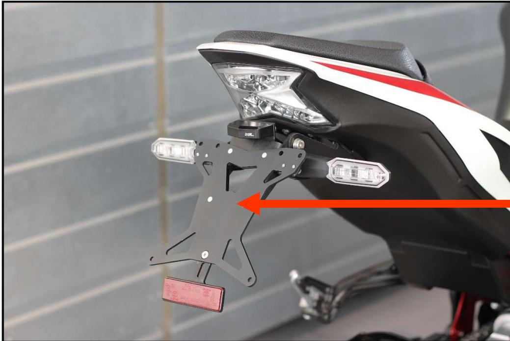
**DE: ACHTUNG:** Montieren Sie nur Ihr Nummerntafel – verwenden Sie keine zusätzliche Stahl- oder Aluminium-Trägerplatte – dies kann zu Bruchschäden an der Halterung führen!!
