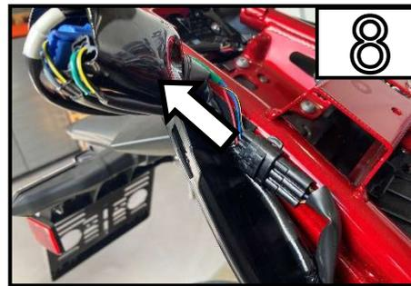
Ziehen Sie den Kabelbaum aus der Verkleidung hinaus um an die Stecker zu gelangen / Pull the wiring harness out of the rubber bag to access the connectors
