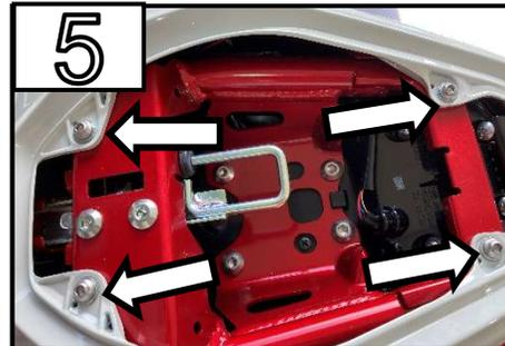
Entfernen Sie alle 4 markierten Schrauben /
