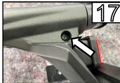
Entfernen Sie die Schraube neben der Kennzeichenbeleuchtung und teilen Sie die beiden Hälften des Kennzeichenhalters /
