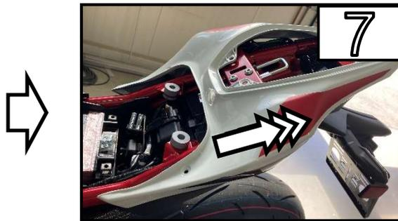
Schieben Sie Plastikverkleidung nach hinten und entfernen Sie diese / Gently slide the bodywork towards the rear and remove it
