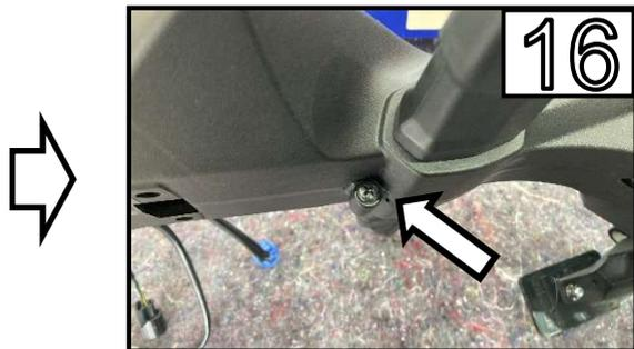
Entfernen Sie die Schraube neben dem Blinker /
