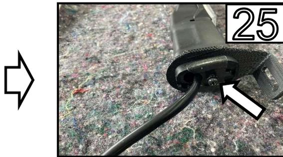
Befestigen Sie das Sicherungsblech wieder am Blinker. /
