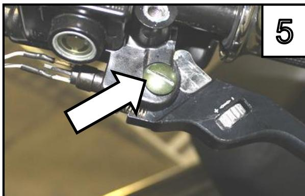
Montieren Sie den MG Biketec Hebel so wie der originale angenommen wurde (Distanzscheiben nicht vergessen). ACHTUNG: Der Hebel darf den Bremszylinder nicht vorspannen! /
