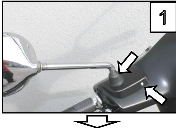
Entfernen Sie die Spiegel und danach die Abdeckung der Bremsflüssigkeitsbehälter. /
