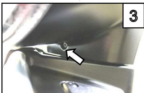
Entfernen Sie die Schraube auf der Unterseite des Scheinwerfers um die Frontverkleidung abnehmen zu können. /
