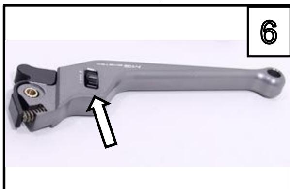
Der Hebel ist durch Drehen des Verstellrads im Abstand einstellbar. /
