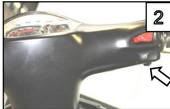
Zur Demontage der Frontverkleidung entfernen Sie die beiden Schrauben (links & rechts) auf der Rückseite/Unterseite /
