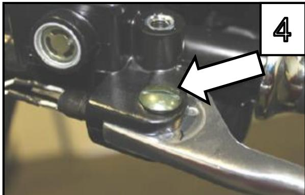
Zum Entfernen des originalen Hebels, lösen Sie die Mutter auf der Unterseite und entfernen Sie die Befestigungsschraube des Bremshebels. Entnehmen Sie die beiden Distanzscheiben vom originalen Hebel. /
