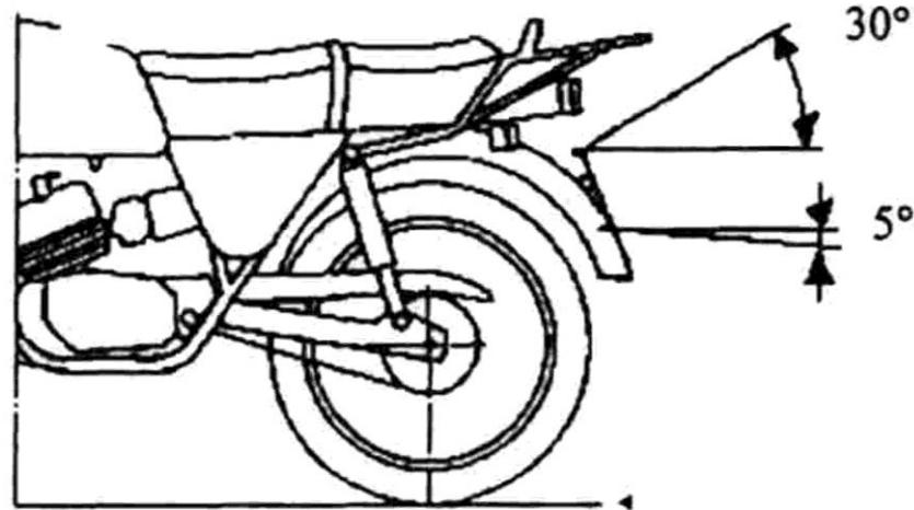
Nach Abschluss der elektrischen Installation, montieren Sie den vormontierten Kennzeichenträger an die originalen Montagepunkte.
