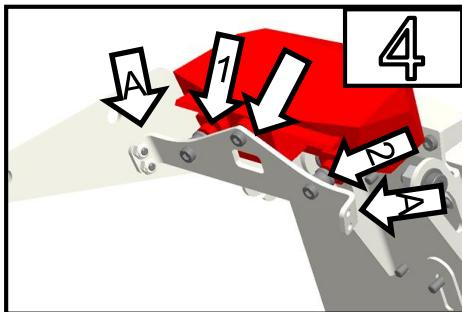
Montieren Sie das Rücklicht am Kennzeichenträger mit beide Distanzhülsen (Pfeil 1&2) (ziehen Sie die 4 Schrauben der Trägerplatte des Rücklichts noch nicht fest – Pfeil A) /
