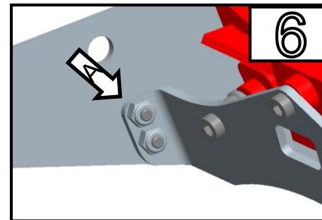
Richten sie die Position des Rücklichts ein und ziehen Sie anschließend die 4 Schrauben & Muttern fest (Pfeil A) /
