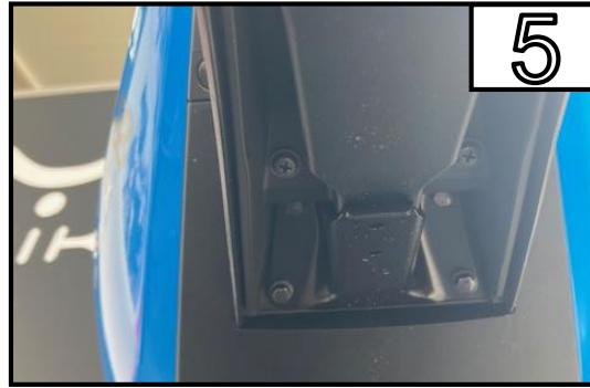
Entfernen Sie die 4 Befestigungsschrauben des Halters.
