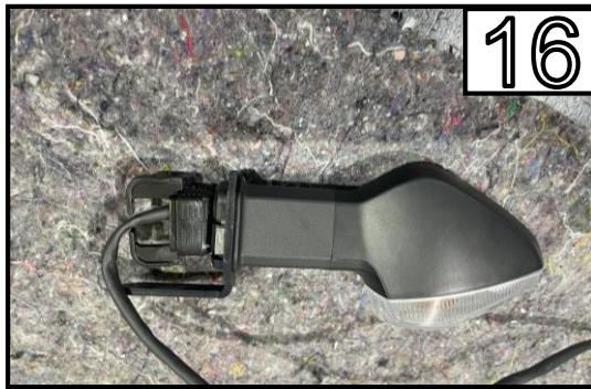
Montieren Sie den Blinker in den Blinkeradapter
