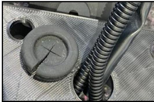
Führen Sie den Gummiring auf die Kabel und
