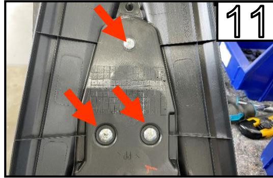
Entfernen Sie die 3 Schrauben.
