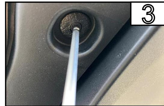
Durch hinein drücken des Kunststoffbolzen entriegeln Sie den Clip. Danach können Sie den ganzen Clip heraus ziehen.
