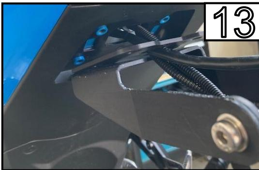
Montieren Sie das neue Heck am Motorrad mit dem mitgelieferten M6 Schraubenset.
