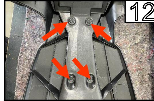
Entfernen Sie die 4 Kunststoffclips.
