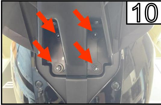
Entfernen Sie die 4 Schrauben und den
