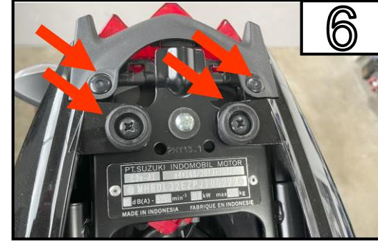
Entfernen Sie die 2 Kunststoffbolzen.
