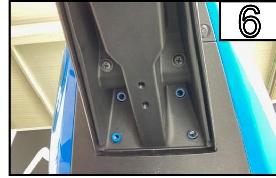
Entfernen Sie die übrigen 2 Schrauben und entfernen Sie vorsichtig die Kennzeichenhalterung.
