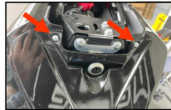
Entfernen Sie die 2 Schrauben.
