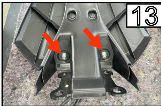
Entfernen Sie die 2 Schrauben und die Abdeckung.
