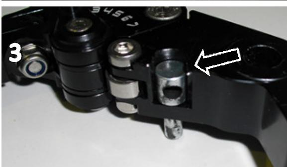
Originale Buchse in Hebel verbauen und dabei etwas Schmierfett verwenden (Bild 3)
