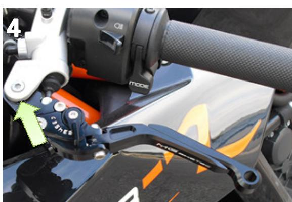
Bauen Sie den Hebel mit der Originalhülse, Originalschraube und -mutter wieder an. Ziehen Sie die Mutter mit einem Drehmoment von 4,5 Nm fest (Bild 4).
