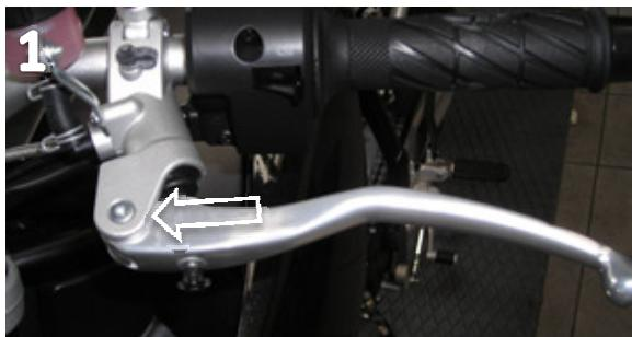
Entfernen Sie die originale Befestigungsschraube indem Sie die Mutter an der Unterseite abdrehen und anschließend die Schraube herausdrehen (Bild 1)
