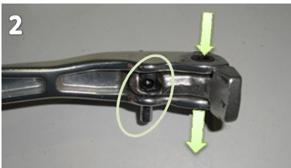
Hülse von der Unterseite des Originalhebels mit Hilfe eines 9mm Dorn herausdrücken
