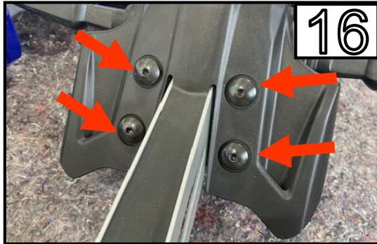
Entfernen Sie die 4 Schrauben.
