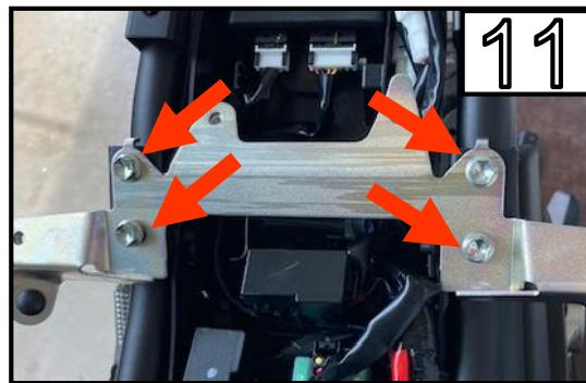
Entfernen Sie die 4 Schrauben für den Grundträger.
