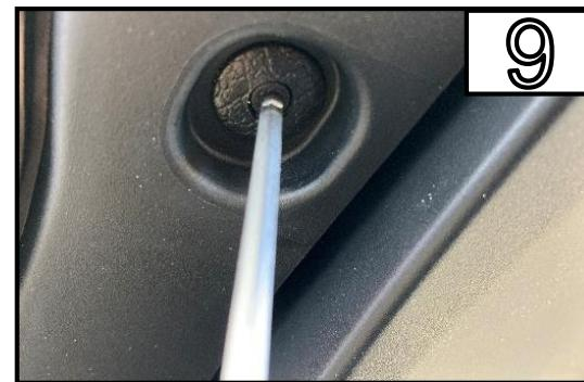
Durch hinein drücken des Kunststoffbolzen entriegeln Sie den Clip. Danach können Sie den ganzen Clip heraus ziehen.
