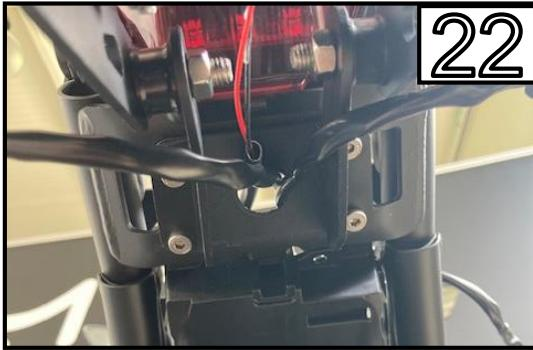
Montieren Sie das neue Heck am Motorrad mit den originalen M6 Schrauben.
