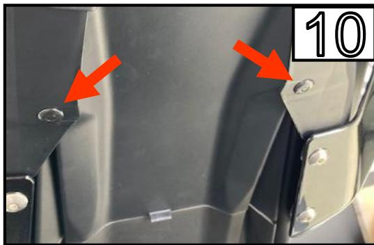
Entfernen Sie die 2 Kunststoffclips und entfernen Sie die seitlichen Verkleidungen. (L&R)
