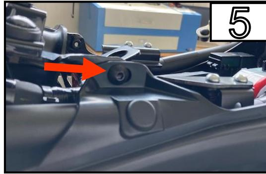
Entfernen Sie die Schraube. (L&R)
