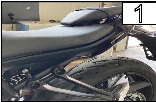
Entriegeln Sie die Sitzbank mit dem Fahrzeugschlüssel und entfernen Sie diese.
