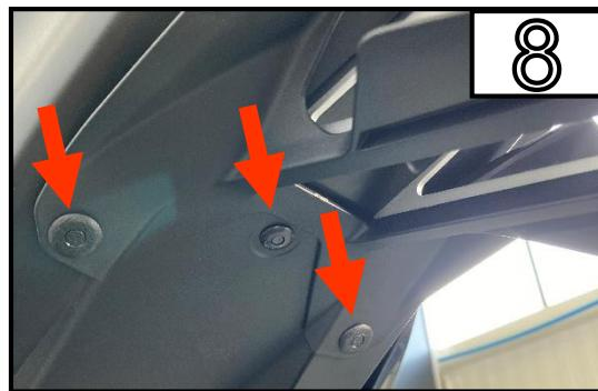
Entfernen Sie die 3 Kunststoffclips und entfernen Sie die Abdeckung.
