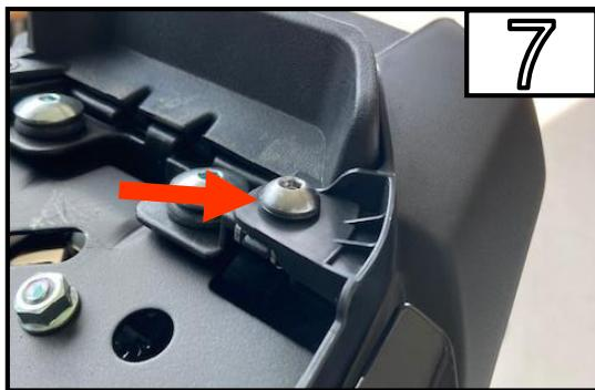
Entfernen Sie die Schraube.(L&R)
