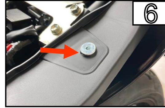
Entfernen Sie die Schraube. (L&R)
