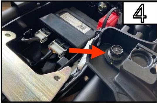
Entfernen Sie die Abdeckung und entfernen Sie die Schraube. (L&R)
