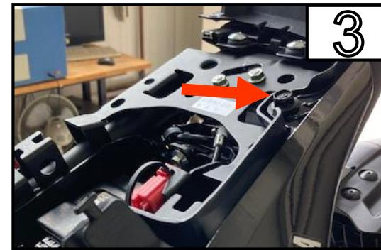
Entfernen Sie die Schraube. (L&R)
