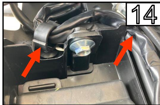
Kabeln aus der Führung und dem Clips lösen.
