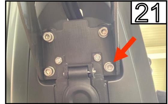
Montieren Sie das neue Heck am Motorrad mit dem mitgelieferten M6 Schraubenset und den originalen Distanzen.
