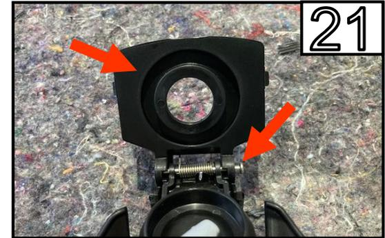
Stift, Feder und Klappe von der originalen Abdeckung entfernen.
