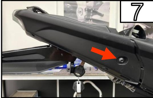
Entfernen Sie die Schraube und seitliche Verkleidung.
