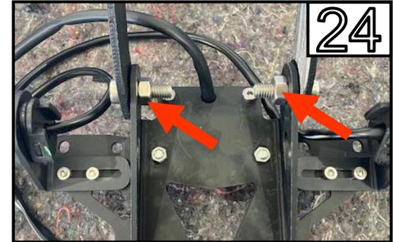
Verbinden Sie den Adapter mit der Kennzeichenplatte mit den mitgelieferten M8 Schraubenset.
