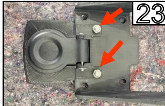
Fertige Schlüsselabdeckung am Bike Adapter mit den mitgeführten M5 Schraubenset montieren.
