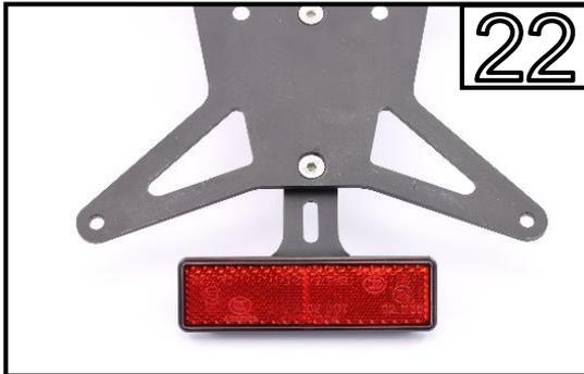
Montieren Sie den beigelegten Reflektor am MG Biketec Kennzeichenträger.
