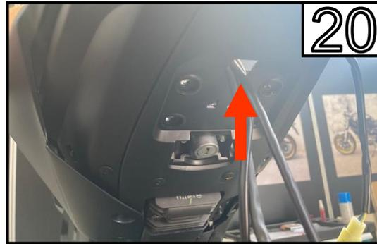
Führen Sie die 3 Kabel durch die Aussparung.
