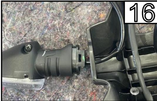
Entfernen Sie den Blinker aus dem Kennzeichenträger.
