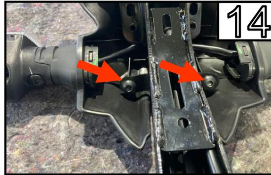
Entfernen Sie die 2 Schrauben und den Bügel.
