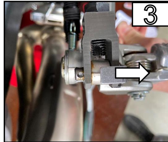
Entfernen Sie zuerst die Schrauben (1), welche den Bremszylinder an der Fußraste hält.
