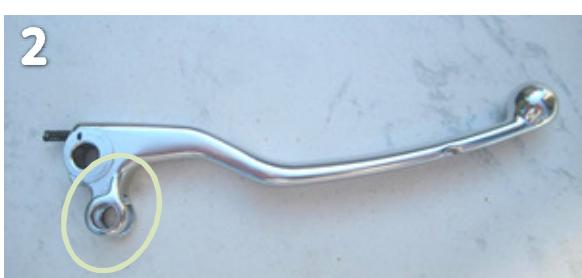
Hülse des Originalhebels mit Hilfe eines 8mm Dorn herausdrücken
