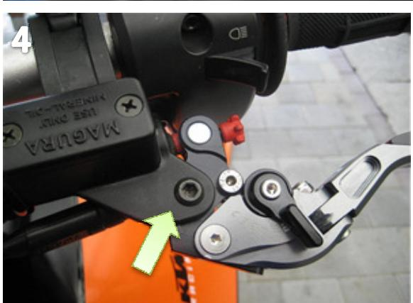
Bauen Sie den Hebel mit der Originalhülse, Originalschraube und -mutter wieder an. Ziehen Sie die Mutter mit einem Drehmoment von 4,5 Nm fest (Bild 4).
