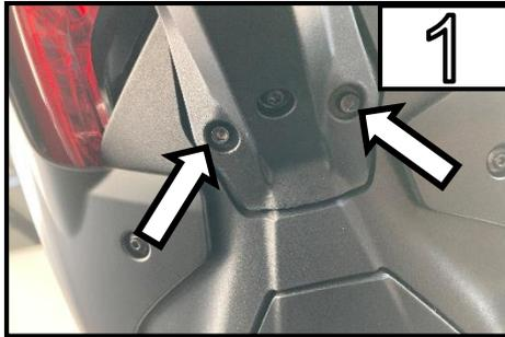
Entfernen Sie die beiden Schrauben welche den Kennzeichenträger am Rahmen hält. /
