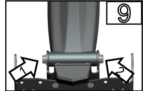
Montieren Sie den Kennzeichenträger am Adapter. Verwenden Sie bei Pfeil 1 (linke Seite) die M8x65 Schraube und bei Pfeil 2 (rechte Seite) die M8x16 Schraube. (Einkleben) /
