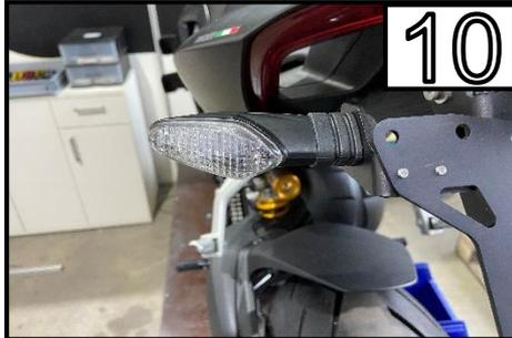
Montieren Sie die Blinker in die mitgelieferten Haltern. /
