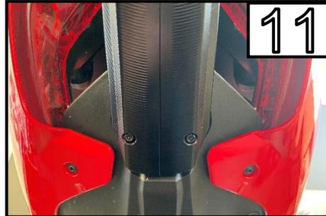
Montieren Sie den Kennzeichenträger mit den beiden originale Schrauben an den originalen Anschraubpunkten. /
