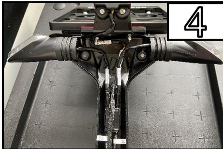
Entfernen Sie den Kunststoff (Oberteil des Kennzeichenträgers) um, wie im Bild gezeigt, an die Blinker und die Kabeln zu kommen. /
