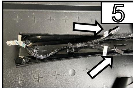
Trennen Sie die beiden Stecker der Blinker und dem Stecker der Kennzeichenbeleuchtung. /
