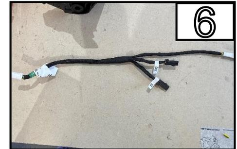
Entfernen Sie den Kabelbaum vollständig vom originalen Kennzeichenträger und verbinden Sie es mit den Blinkern und der neuen Kennzeichenbeleuchtung. /
