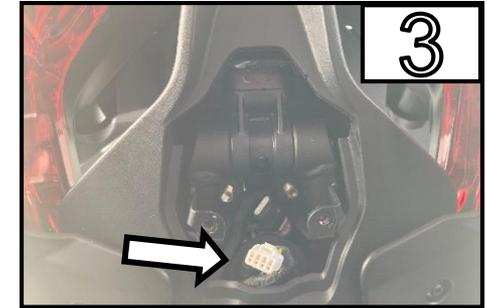
Trennen Sie den Hauptstecker des Kennzeichenträgers und entfernen Sie diesen vollständig. /
