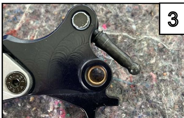
Originale Kolbenstange und Buchse mit ein wenig Fett in den MG Biketec Hebeladapter verbauen.
