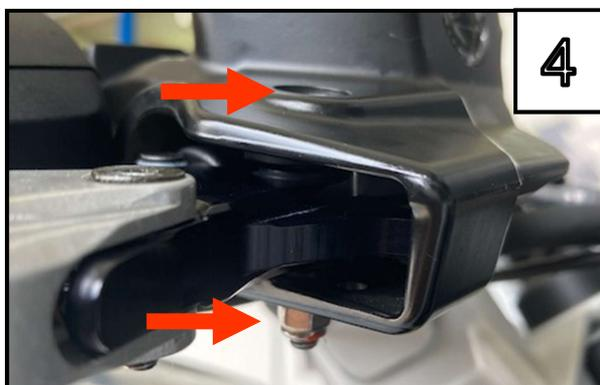
Führen Sie den MG Biketec Hebel auf seine Position und befestigen Sie den Hebel mit der Schraube wieder.
