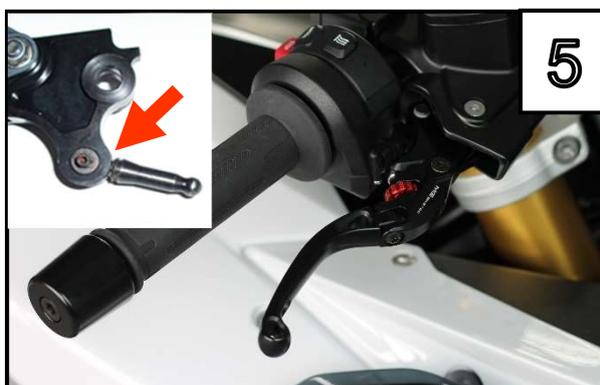
Mithilfe der Einstellschraube an der Buchse der Kolbenstange können Sie den korrekten Abstand von Hebel zur Pumpe einstellen.
