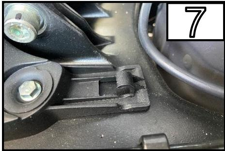
Entfernen Sie das Kabel aus der Führung
