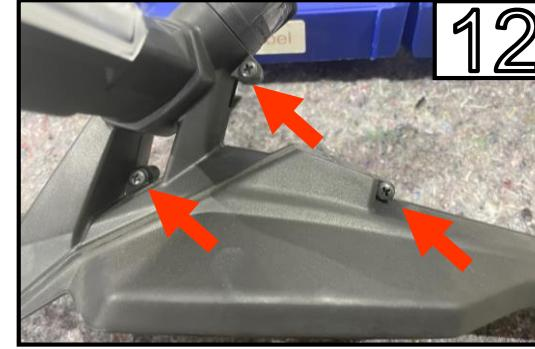
Entfernen Sie die 3 Schrauben.
