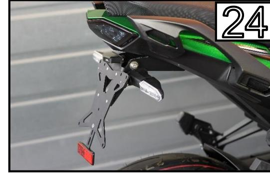
Montieren Sie das neue Heck am Motorrad mit dem mitgelieferten M6 Schraubenset.
