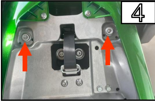
Entfernen Sie die 2 Schrauben und den Bügel auf der L & R.
