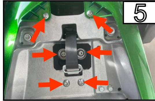
Entfernen Sie die 6 Schrauben.
