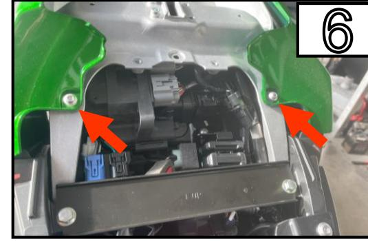
Entfernen Sie die 2 Schrauben und die Verkleidung.
