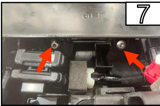
Lösen Sie die 2 Schrauben.
