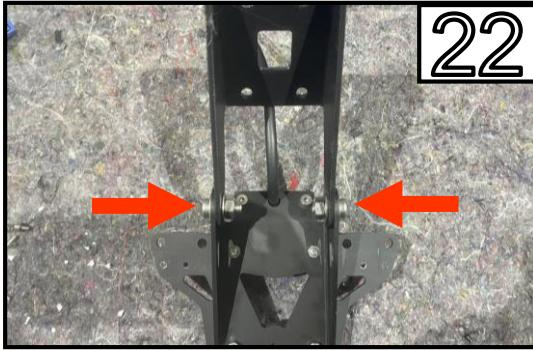
Verbinden Sie den Adapter mit der Kennzeichenplatte mit der mitgelieferten M8 Schrauben, Beilagscheiben und Mutter.
