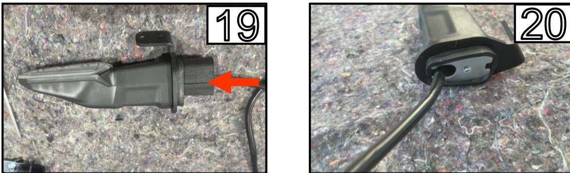
Montieren Sie die Metallplatte wieder im Blinker.
