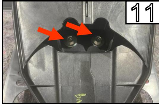
Entfernen Sie die 2 Schrauben.
