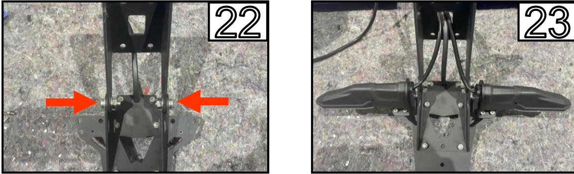
Montieren Sie die Blinkerhalter am Kennzeichenträger und führen Sie die Kabel durch den Ausschnitt.
