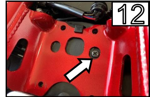
Entfernen Sie die Kreuzschraube und stützen Sie den Träger am Hinterrad ab /
