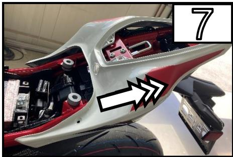
Schieben Sie Plastikverkleidung nach hinten und entfernen Sie diese /
