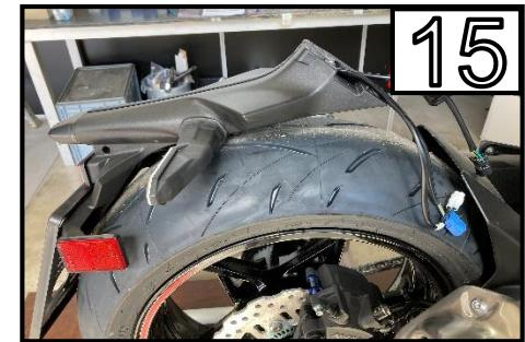
Ziehen Sie die 3 Kabel raus und entfernen Sie anschließend den Kennzeichenträger vom Motorrad /
