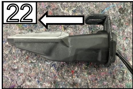
Montieren Sie den Blinker in der Halterung
